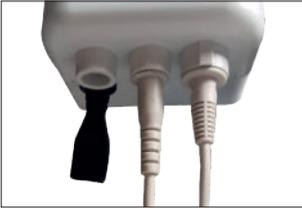
Avant l'utilisation, vérifier que la télécommande et le vérin sont correctement branchés au bloc de contrôle (page 24).
