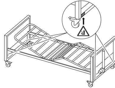
1. Placez les quatre autocollants d'avertissement de serrage du pied (fournis séparément) sur les côtés inférieurs des panneaux du lit, près des roulettes.
