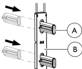
En partant de l'arrière, introduisez le cliquet **A** dans le coulisseau **B** jusqu'à ce que le déclic de verrouillage se fasse entendre.
