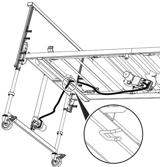
9. Placez l'extrémité de la partie enroulée du câble du moteur de montée/descente sur le crochet du panneau.
