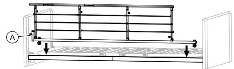
Placez la barrière au-dessus du cadre avec le système de déverrouillage **A** côté tête du lit.
