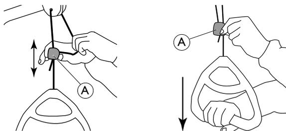
1. Tirez le cordon sur le côté et faites glisser le système de blocage **A** vers le haut ou vers le bas jusqu'à ce que la poignée se trouve à la hauteur souhaitée.
