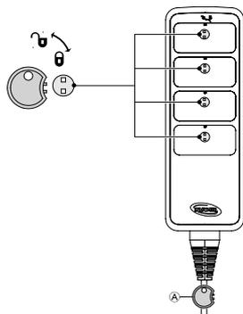
1. Insérez la clé ① dans le trou situé juste au-dessus de la fonction souhaitée.
