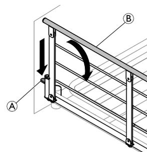
1. **Haut** : soulevez et tirez le barreau supérieur ② de la barrière vers l'extrémité avec le mécanisme de verrouillage (bouton de déverrouillage) ①. Vérifiez qu'il est bien verrouillé.
