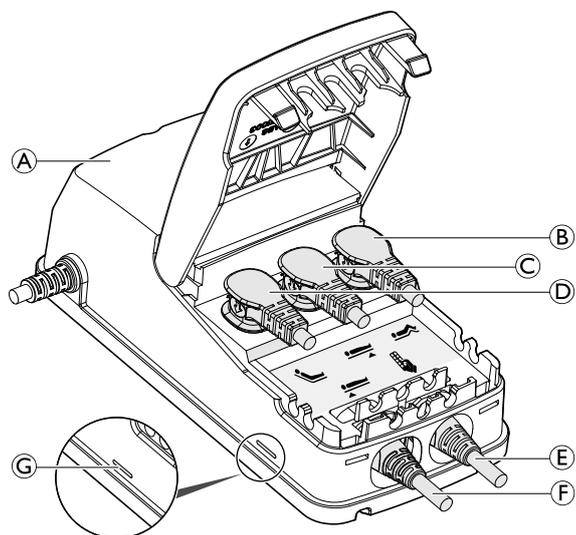
L'unité centrale **A** comporte une étiquette sur laquelle figurent les symboles indiquant l'emplacement où la fiche des moteurs doit être branchée :
