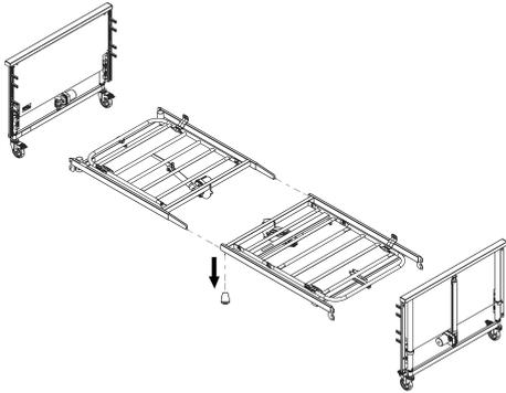
2. Poussez les tiges de la partie tête du plan de couchage dans les tubes latéraux de la partie pieds du plan de couchage.
