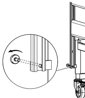
Resserrez la vis au-dessous du barreau inférieur de la barrière, au coin de chacune des extrémités du lit.
