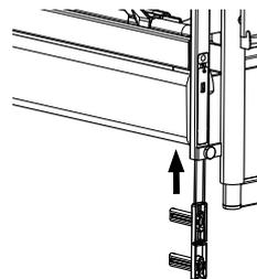
Poussez la fixation dans le guide jusqu'à ce qu'elle s'enclenche avec un clic audible (cela indique qu'elle est correctement fixée en position inférieure).
