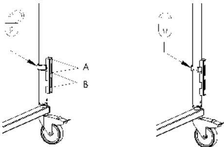
6. Verrouillez les supports du plan de couchage en position haute (A) ou en position basse (B) au niveau du panneau et appuyez fermement pour les enclencher (il est normal qu'il y ait un petit espace entre la fente supérieure et le support).
