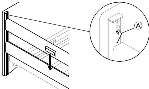
Appuyez sur le verrou du système coulissant **A** situé à l'une des extrémités du lit et abaissez la barrière dans la position la plus basse.
