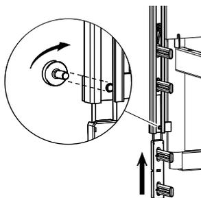
Desserrez la vis dans la partie inférieure des guides sur l'un des panneaux du lit et poussez le coulisseau à mi-course dans le guide jusqu'à ce qu'il s'enclenche avec un clic audible.
