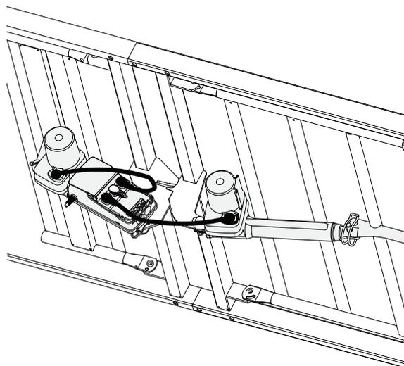
4. Faites passer le câble d'alimentation à travers la broche du moteur et le crochet du châssis sur le côté du lit qui est le plus près de la prise électrique.
