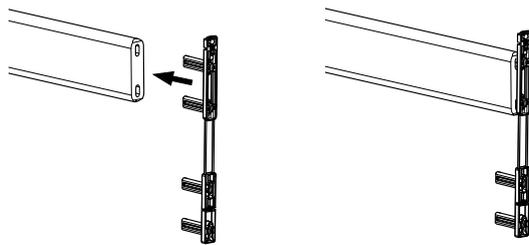
À l'autre extrémité du barreau de la barrière, poussez les deux cliquets supérieurs contre l'extrémité du barreau.
