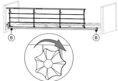
Serrez les vis à molette **B** pour fixer la barrière au cadre. Assurez-vous qu'elle est stable et correctement serrée.
